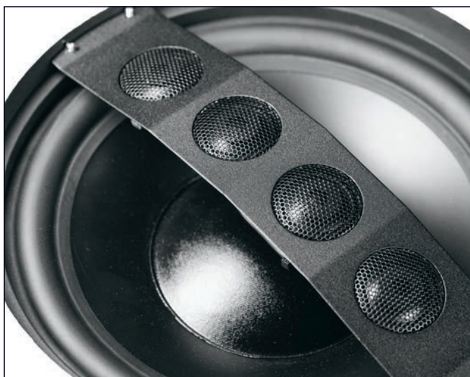
Vor dem Zehn-Zoll-Konus sitzt das gebogene 4er-Array aus Hochtö-nern koaxial und sorgt wie ein Zeilenstrahler für vertikale Bündelung.
