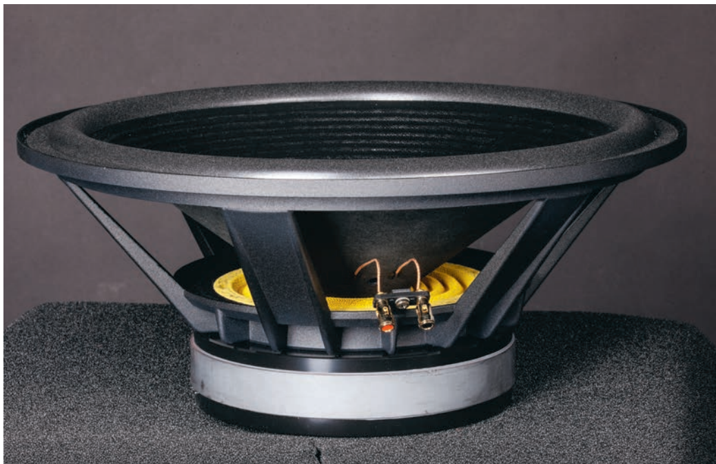
Der 16-Zoll-Basstreiber vereint mit seiner harten Pappmembran und starkem Gusskorb einerseits, der Schaumstoffsicke und kleiner Schwingspule andererseits Beschallungs- mit HiFi-Genen.
